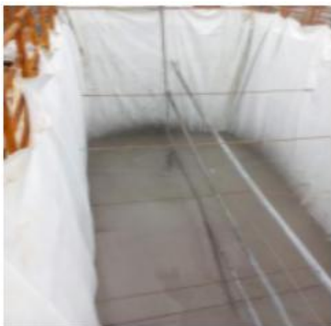
图2.4-3充填分区采场内的流平效果
